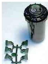
Turbine escamotable à faible débit - Un seul modèle réglable et plein cercle - Pression d'utilisation : 2,1 à 3,4 bars - Portée 4,5 à 9,1 m
