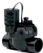
Électrovanne 1" femelle x femelle en ligne - Solénoïde 24 ou 9V à fils - Ouverture manuelle par rotation 1/4 de tour du solénoïde - Vis de purge
