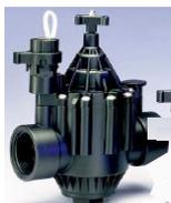
Électrovannes plastiques pour grands espaces et terrains de sport - Solénoïde 24V à fils - Ouverture manuelle par rotation 1/4 de tour du solénoïde - Utilisation en ligne ou angle - Pression utile : 1,0 à 10,4 bars - Débit entre 0,5 et 34,0 m<sup>3</sup>/h (200PGA) - Poignée de réglage du débit
